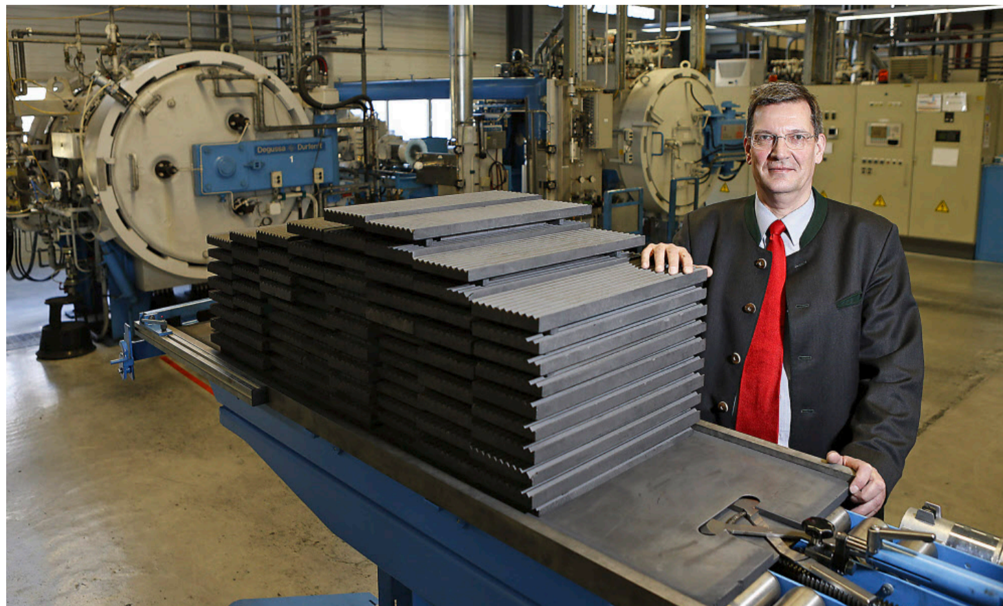
Weisse Öfen: Extramet-Chef Hans-Jörg Mihm in einer Werkhalle. Stabförmige Teile werden auf diese Platten gelegt und in den Öfen erhitzt.
