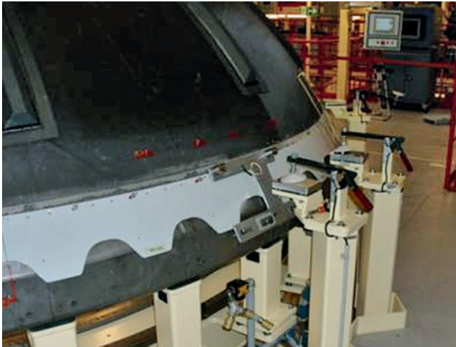
2 Druckkalotte des A380: Beim Bohren des CFK-Titan-Aluminium-Verbundes mit einem diamantbeschichteten Bohrer aus EMT100 wurde eine Standzeitverlängerung von 140 Prozent realisiert
