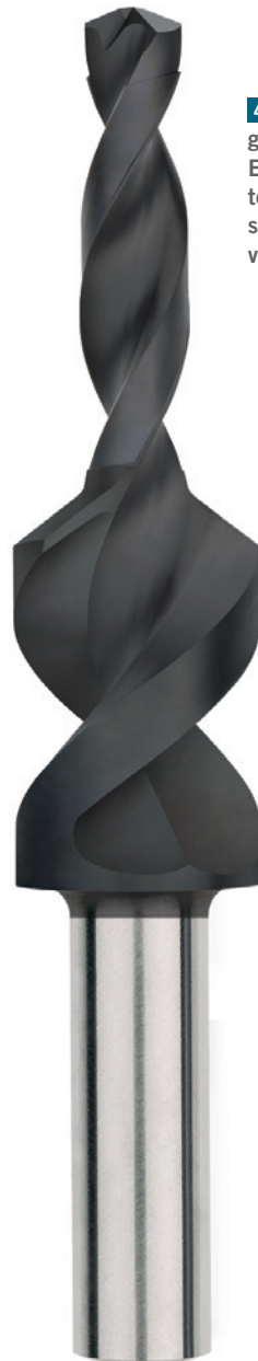
2 Druckkalotte des A380: Beim Bohren des CFK-Titan-Aluminium-Verbundes mit einem diamantbeschichteten Bohrer aus EMT100 wurde eine Standzeitverlängerung von 140 Prozent realisiert
