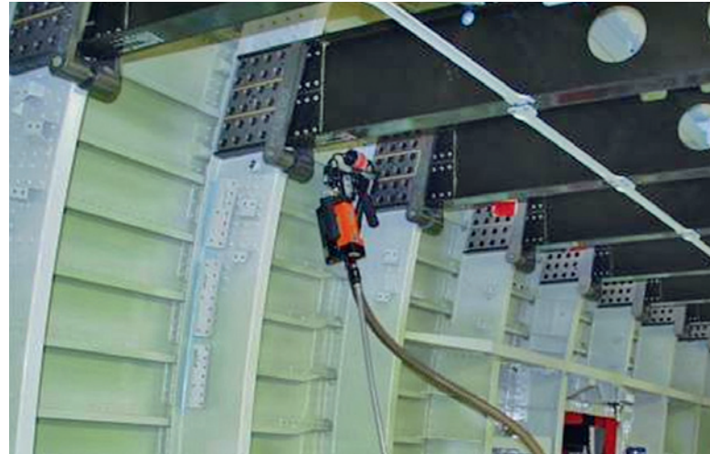
3 Querträger-Spant-Verbindung des A380: Mit dem Einsatz diamantbeschichteter Werkzeuge aus EMT100 ließ sich die Standzeit beim Bohren von CFK/Titan und Al/Al um mehr als das Zehnfache steigern
