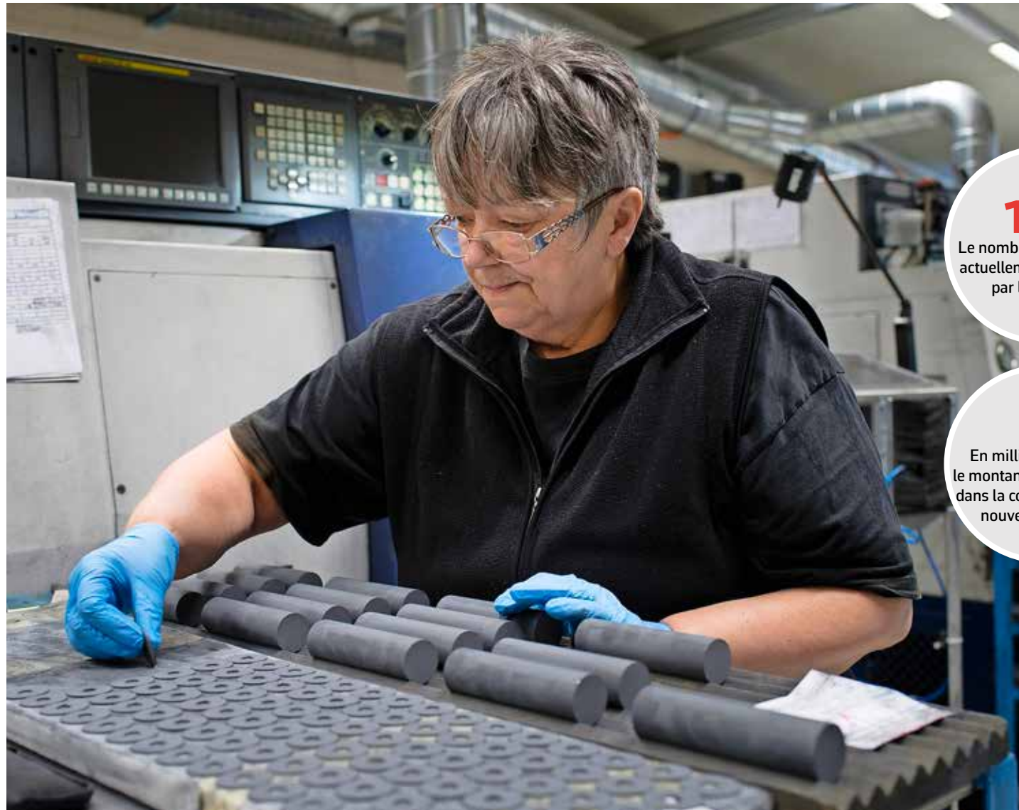
Extramet veut doubler sa capacité de production dans le domaine du taillage. Cette étape consiste à usiner des outils semi-finis dans des barres de métal dur fabriquées à Planfayon. Alain Wicht
